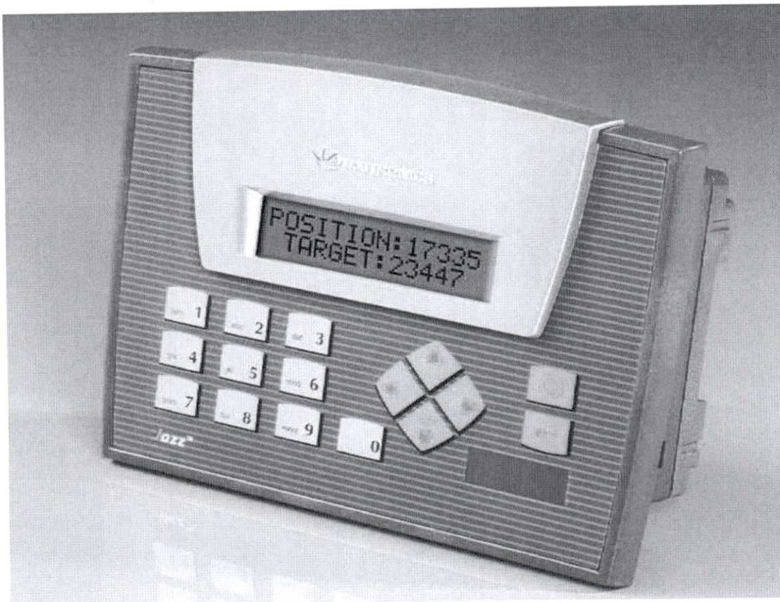
Rys. 9.1. Widok panelu operatorskiego przełącznika programowalnego.
