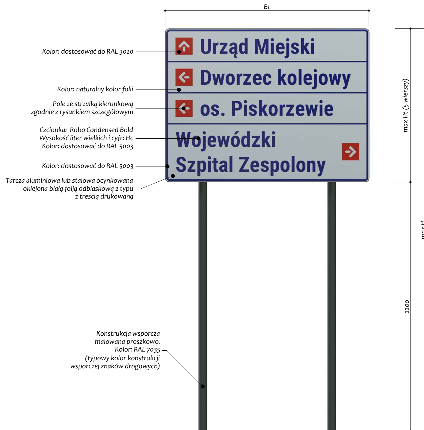
Rysunek architektoniczny tablic i konstrukcji wsporczej. Skala 1 : 20
