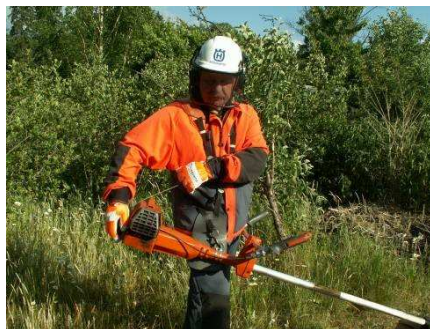
Rys.2 Dopuszczalne sposoby uruchamiania pilarki z urządzeniem tnącym na wysięgniku
