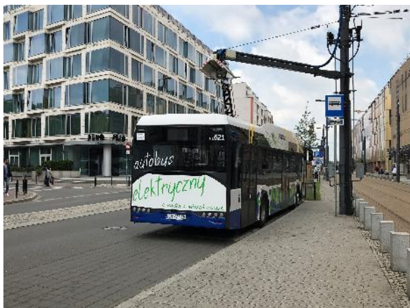
Rys. 2.4 Autobus elektryczny akumulacyjny na stacji szybkiego ładowania w Krakowie
